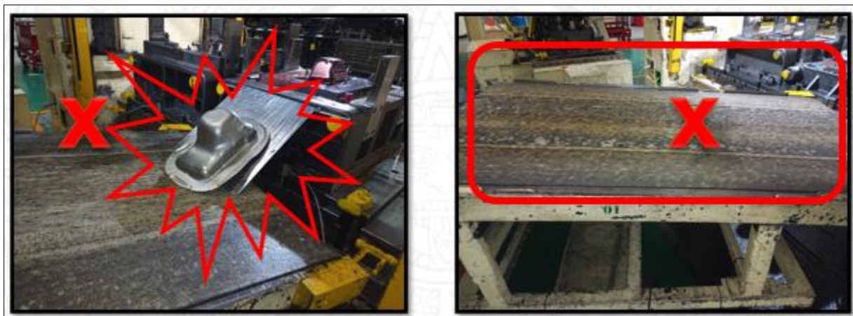
Imagen 28 caída de pieza y desgaste en banda
