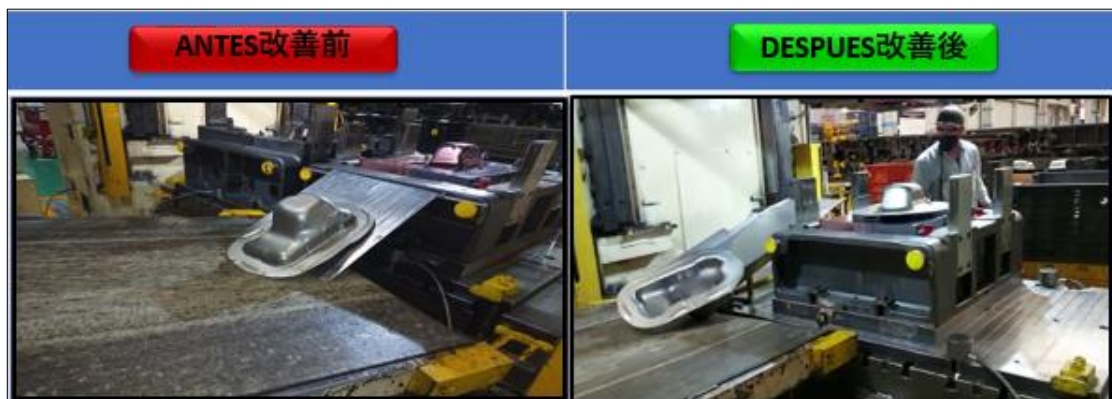
Imagen 44 retiramiento de troquel
