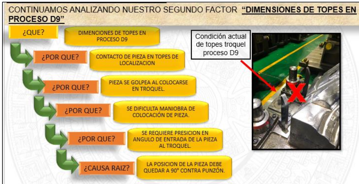
Imagen 29 Dimensiones de topes en proceso D9.
