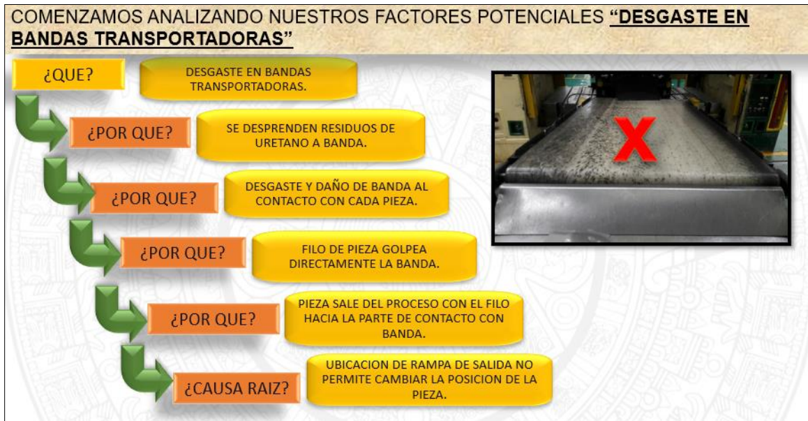
Imagen 27 Factores de desgaste en bandas transportadoras.
