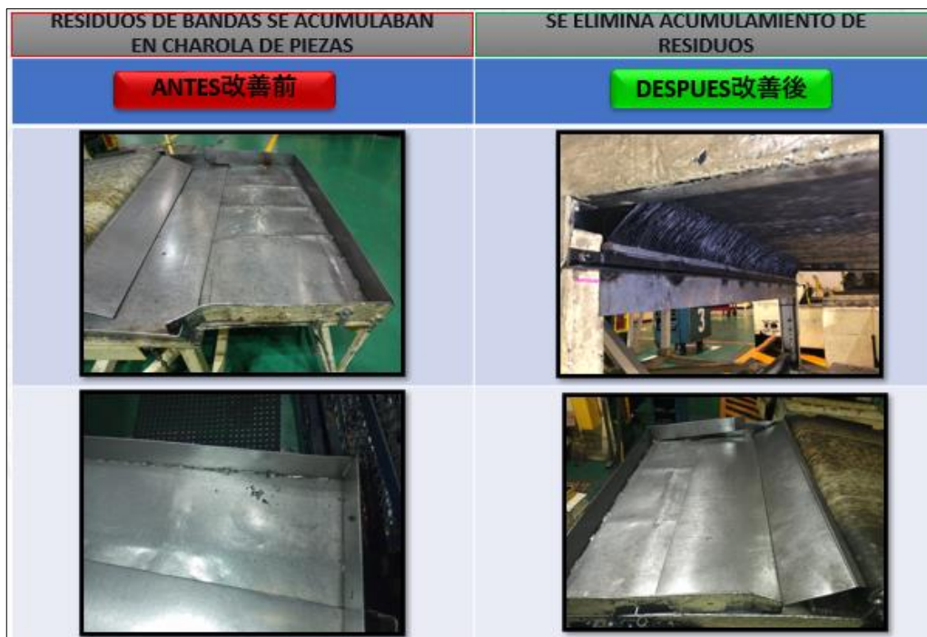
Imagen 43 mejora en cepillos y banda transportadora
