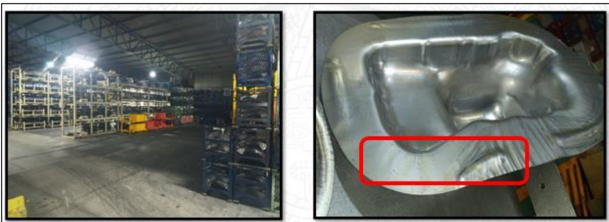
Imagen 32 material en almacén y marcas que salen de la pieza
