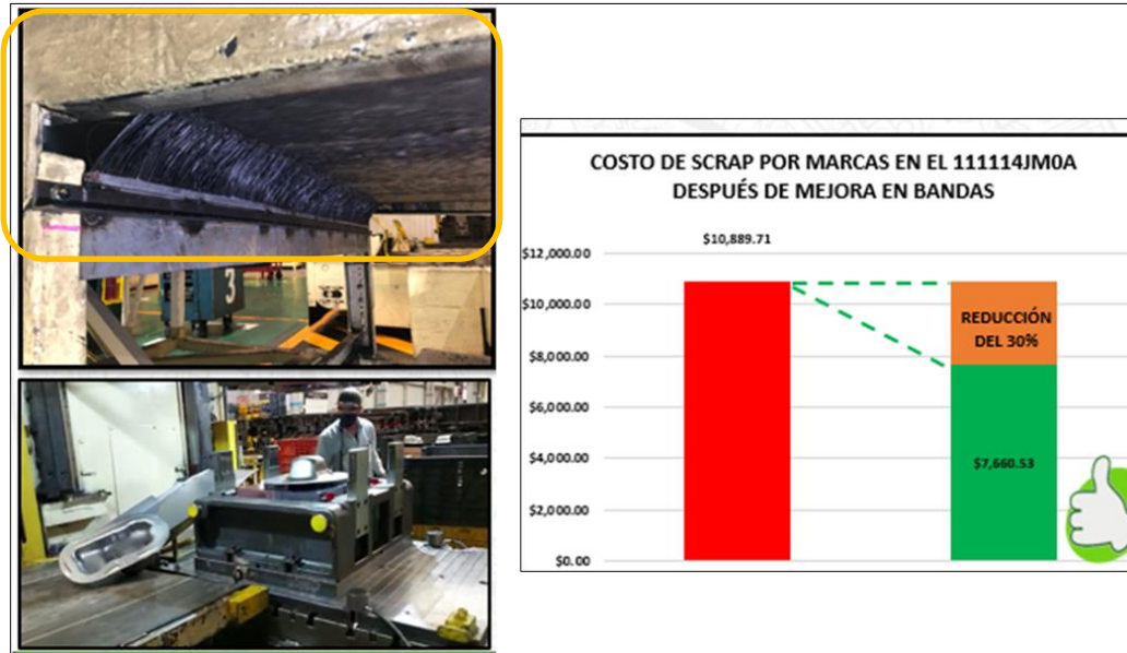
Imagen 42 colocación de cepillos en bandas
