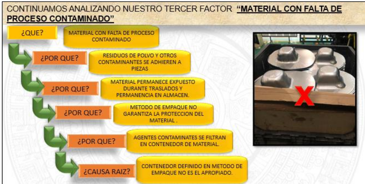
Imagen 31 material con falta de proceso contaminado
